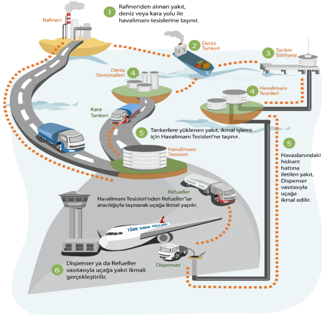
Şekil 1: Jet Yakıtı İkmal Süreci 3
